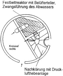
In einer 6 m³ 3-Kammer-Grube:
