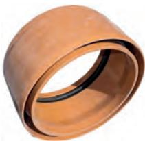
Für wandverstärktes Schachtmaterial nach EN 1917 DIN V 4034/1, Typ 2, Nennweite 1000 mm, Bauhöhe 650 mm bis UK Muffe, Bodenstärke 210 mm bis Gerinnesohle, lichte Höhe von Sohle Gerinne bis OK außen 440 mm, **Gerinne mit Steinzeughalbschale bis Kämpfer**, bis Scheitel in Beton, Berme 1:20 in Beton, Wandstärke 150 mm, Gewicht 1,5 to, Gefälle 1,5 % (15 mm Höhenunterschied von Einlauf zu Auslauf).
