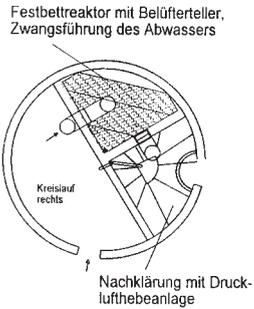
In einer 6 m<sup>3</sup> 3-Kammer-Grube:
