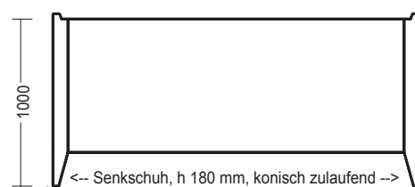
Abteufung (Falz) DN 2000 mm, h 1000 mm
