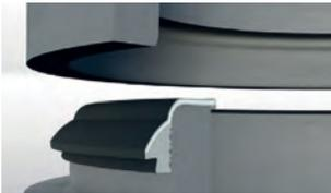
1. Gleitringdichtung Classic - Gleitmantel nach oben und außen zeigend - auf das saubere Spitzende aufziehen. Vorspannung durch mehrfaches Ziehen an verschiedenen Stellen gleichmäßig verteilen. Auf richtigen Sitz der Dichtung an der Schulter achten.
