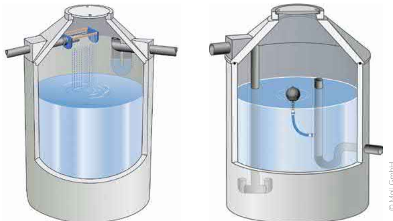
Schematische Darstellung von Regenwasserzisternen.
